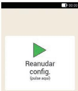
Los datos y ajustes introducidos se almacenan temporalmente en distintos puntos durante la configuración. Los llamados puntos de reanudación son puntos durante el proceso de configuración en los que se guardan los ajustes realizados hasta el momento. Si después de una interrupción desea reanudar la configuración, aparece la indicación **Reanudar config.**.
