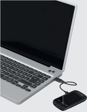
Enchufe el conector grande (conector USB tipo A) del cable USB en un puerto de carga USB libre del ordenador/de la computadora. El puerto de carga USB a menudo está marcado con
