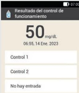
El resultado del control del funcionamiento aparece en la pantalla. Toque en la solución de control utilizada (p. ej. [Control 1](#)).
