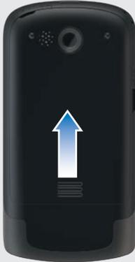
Abra el compartimento de la batería deslizando la tapa hacia arriba como señala la flecha.
