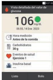
Pantalla Vista detallada del valor de glucosa en el modo para tratamiento con inyección.
