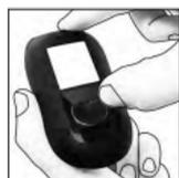
Abra la tapa del compartimento de la pila de la parte posterior del medidor empujando la lengüeta en la
