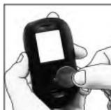
Extraiga la pila usada. Pulse y mantenga pulsada la tecla On/Off/Set durante al menos 2 segundos y, a continuación,
