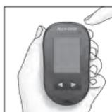
Pulse y suelte **⏏** (tecla On/Off/Set) para encender el medidor.
