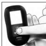
Vuelva a poner la tapa del compartimento de la pila en su sitio y ciérrela de modo que encaje.
